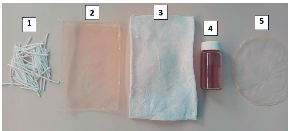
Figura 2. Tipos de PLA y derivados obtenidos del laboratorio de polímeros de la Universidad de Guanajuato, División de Ciencias Naturales y Exactas 1) filamentos, 2) nanocompuesto con nanocelulosa en forma de película, 3) película, 4) líquido viscoso y 5) membrana de filtración.
